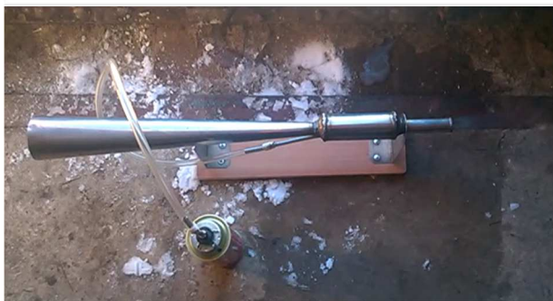
рис. 1 Испытание прототипа двигателя Локвуда-Хиллера
