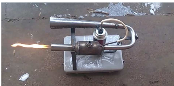
рис. 1 Испытание прототипа двигателя Локвуда-Хиллера
