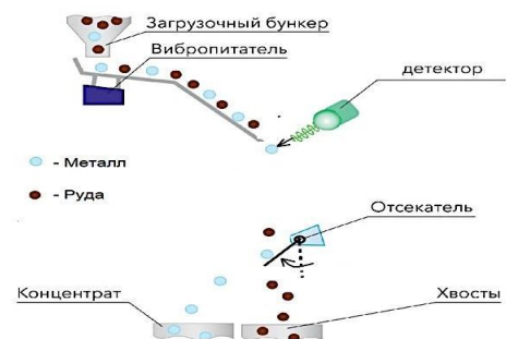
Рисунок 2 – Предложенная схема извлечения металлов и сплавов
