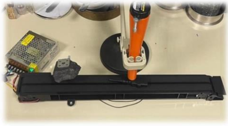
Рисунок 3 - Собранная модель металлоотделителя в работе
