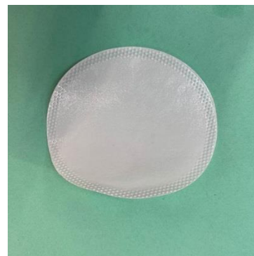
Рис.2. Ультрафильтрационная мембрана из полиакрилонитрила
